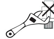
• Après avoir raccordé la robinetterie à l'installation, ouvrir la vanne et observer s'il y a des fuites au niveau les points de raccordement. S'il y a une fuite aux points de raccordement, effectuer un montage approprié pour l'étanchéité du raccordement.
