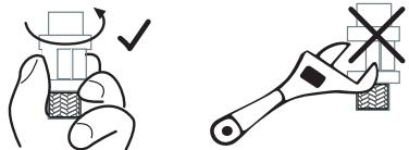
• После подключения арматуры к установке откройте клапан и посмотрите, нет ли утечки в точках соединения. Если есть утечка в точках соединения, произведите соответствующую сборку для герметизации соединения.
