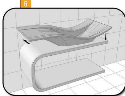
Lavabo tezgah üzerindeki kaplamanın zarar görmeyeceği şekilde, tezgah üzerindeki montaj boşluğu ve batarya eksenine dikkate alınarak montaj pozisyonuna getirilir. Lavabo üzerindeki montaj noktaları duvara işaretlenerek, lavabo tezgah üzerinden alınır.
