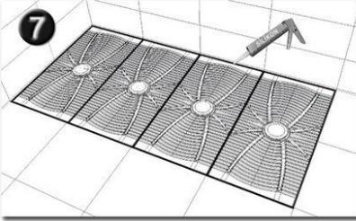
Monte edilecek modüller arasında ~ 3'er mm. boşluk verilmelidir. Bu boşluk; sızdırmazlığı ve bağlayıcılığı sağlayan antibakteriyel özellikli silikon ile tamamen doldurulmalıdır. Bu tür malzeme dışında bağlayıcı özelliği olmayan ve özellikle genişleyen çimento, alçı gibi malzemelerden kesinlikle kaçınılmalıdır.
