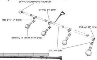
Suyun tahliye olabilmesi için gerekli eğim 2-4 derece arası olması esastır.
