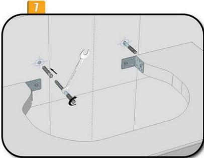
Lavabo montaj delikleri duvar üzerinde hazırlanarak, bu deliklere dübel ve saplamalar sabitlenir.
