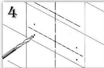
\* Bağlantı pabuçları, perfore çubuğun uçlarına sıfır oturacak şekilde bitmiş duvara çakıştırılır ve montaj delikleri şablon kabul edilerek, gerekli markalamalar yapılır.
