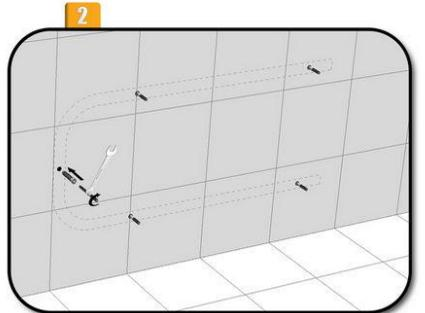
Tezgah montajı için, duvarda hazırlanan deliklere önce dübel, sonra da montaj saplamaları sabitlenir.
