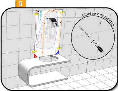
Montaj şablonu, şekildedeki gibi (şablonun B köşesi tezgahın üst-sağ köşesi ile çakıştırılarak) duvara sabitlenir. Mavi ile belirlenmiş olan montaj noktalarına göre duvar delinir. Deliklere dübel ve vidalar sabitlenir.
