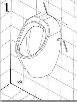
\* Pisuar; alt seviyesi bitmiş döşemeden 650 mm. yüksekliğe gelecek şekilde bitmiş duvara çakıştırılır ve en üst noktasından geçecek şekilde bitmiş duvarda, bitmiş döşemeye paralel yardımcı bir çizgi çizilir.
