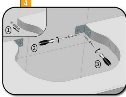
"L" braketler montaj pozisyonuna getirilerek duvara karşılık gelen noktalar belirlenir, bu noktalardan duvara delik açılarak bu deliklere dübel takılır. Daha sonra "L" braketler montaj pozisyonuna getirilerek önce tezgaha, sonra duvara sabitlenir.
