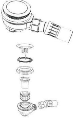
Not Modüler duş ünitesi; montaj altı yapısı hazırlanmak kaydı ile, alttan çıkışlı sifon grupları ile de kullanılabilir.
