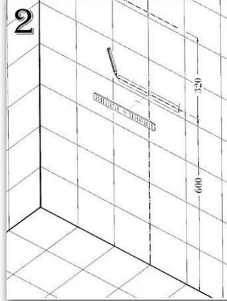
\* Pisuar; alt seviyesi bitmiş döşemeden mm. yüksekliğe gelecek şekilde bitmiş duvara çakıştırılır ve en üst noktasından geçecek şekilde bitmiş duvarda, bitmiş döşemeye paralel yardımcı bir çizgi çizilir.
