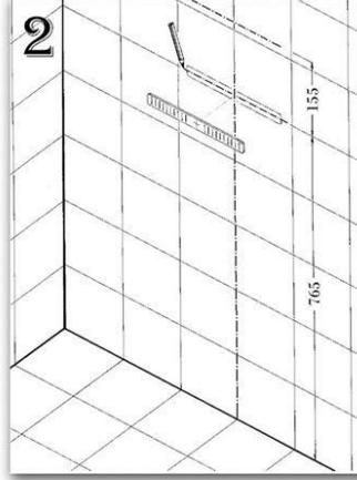
\* Bitmiş duvar üzerinde; önceden çizilen yardımcı çizginin 155 mm. altında, bu çizgiye paralel ikinci bir eksen (montaj eksenini) çizilir.(montaj ekseninin bitmiş döşemeden yüksekliği ~765 mm.'dir.
