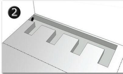
Şapın içinde oluşturulan boşlukta, Ø50 pis su borularının montajı; sızdırmazlık göz önünde bulundurularak yapılmalıdır. Serel EQ montajında kullanılan modül sayısına göre Ø50 pvc borular uygulama bölgesinde ayrı ayrı ölçülerek kesilir. Boruların montajı sonrasında oluşacak boşluk ince, kuru kum ile doldurulmalıdır.
